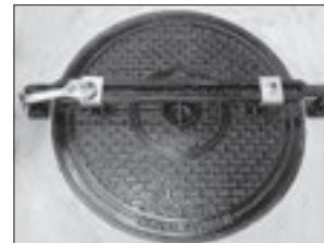
①WC開閉ハンドルとマンホール鉄蓋の取手の位置を合わせて、ボルトフックをマンホール蓋の取手に引掛け、みぞ型金具と六角ナット、ワッシャーで開閉ハンドル本体に固定します。
