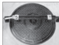
①WC開閉ハンドルとマンホール鉄蓋の取手の位置を合わせて、ボルトフックをマンホール蓋の取手に引掛け、みぞ型金具と六角ナット、ワッシャーで開閉ハンドル本体に固定します。
